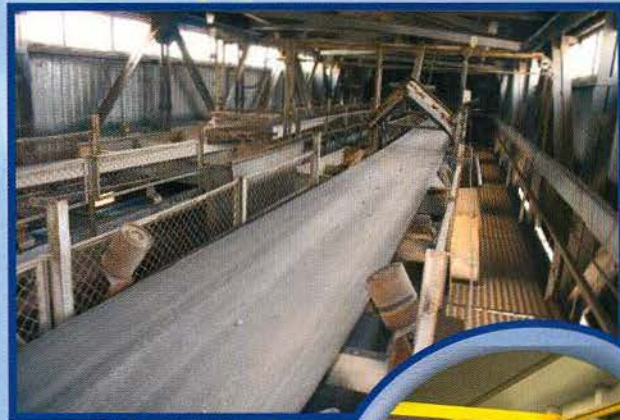
Ленточные конвейеры с плужковыми сбрасывателями
