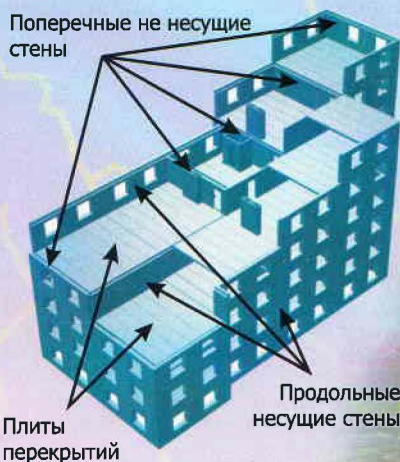
Конструкция здания с несущими поперечными стенами
